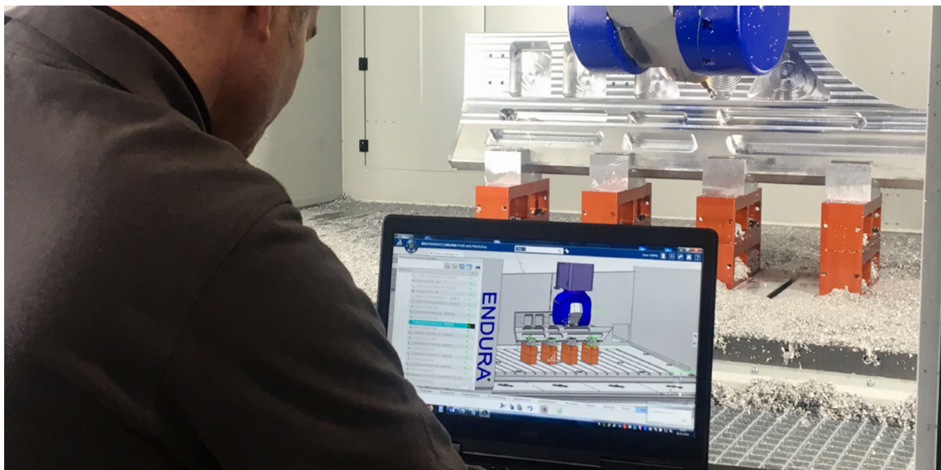
Der reale Werkzeugmaschinenweg entspricht exakt dem virtuellen Modell in der 3DEXPERIENCE Plattform.
